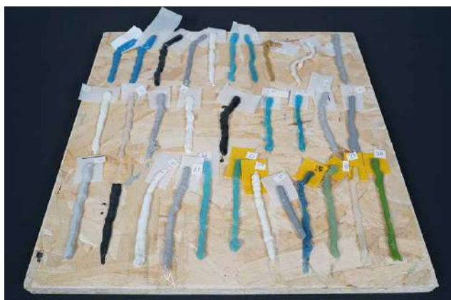
Campagna di test per la valutazione di adesione, coesione ed elasticità di diverse colle e sigillanti.
